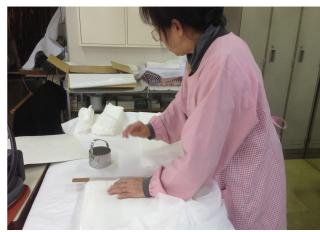
工場長がパターン（型紙）の作製や、生地の裁断をします。その後、担当部門の縫い子さんのもとへ行き、部品が作られます。パターン作製から縫製まで一貫してできるのは、ワカバ縫製工場の特長です。
